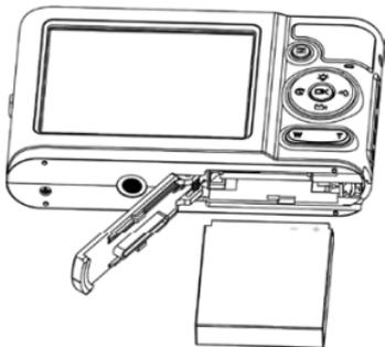
リチウム電池の取り付け
